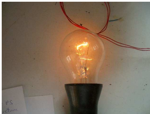
Рис.26 сияющая 100Ватная лампочка, зажженная 2-мя катушками
