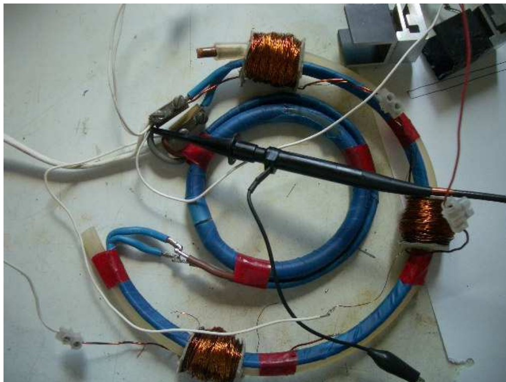
Рис. 10 Финальные 6" две Мёбиус катушки дважды крестом – соединенные
